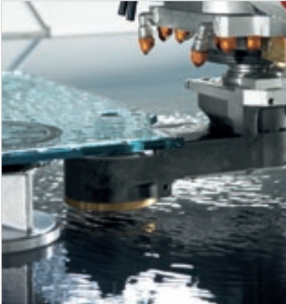
Perforación desde abajo con agregado.
