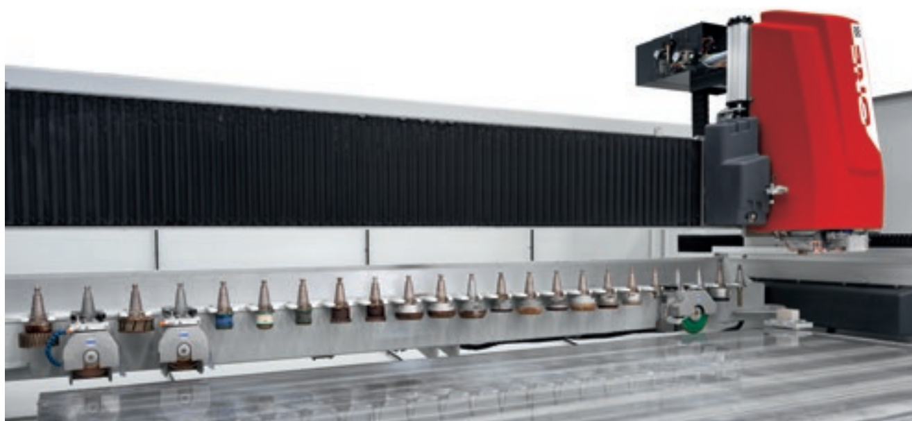
Almacén trasero de herramientas con 23 posiciones.
